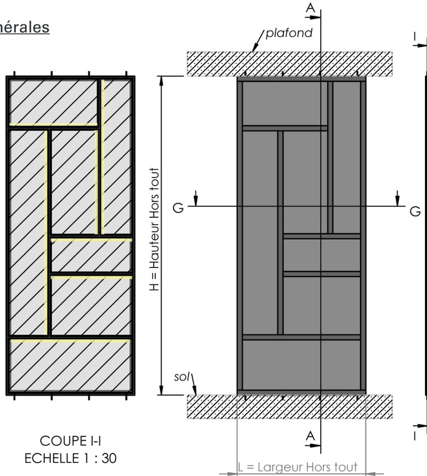
NB: principe de calepinage pour format 2500 x 1000
